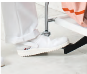
Tretvorrichtung für Scharnierdeckel
