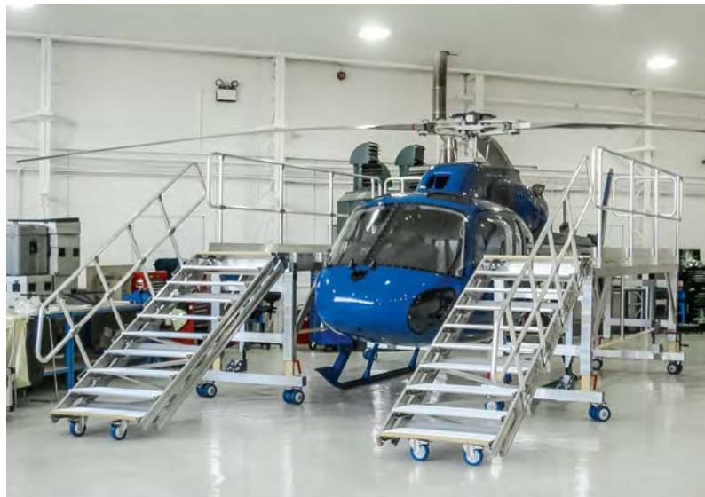
Höhenverstellbare Wartungsbühne für H125
