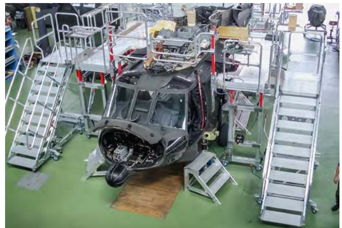
Diese beiden höhenverstellbaren Arbeitsbühnen mit Konturanpassungen ermöglichen optimale Wartungsarbeiten am Black Hawk
