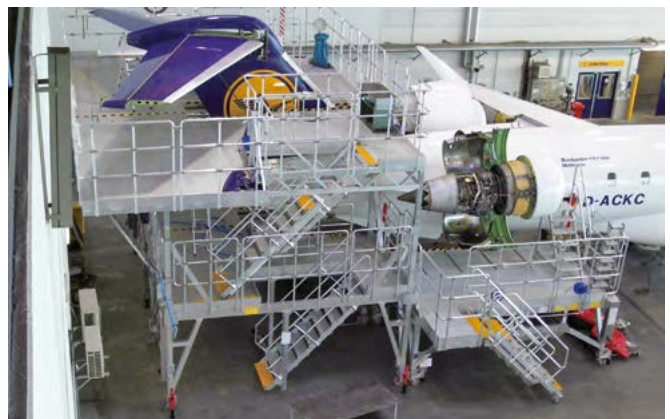
Höhenverstellbares Tail- und Engine-Dock für Bombardier CRJ900
