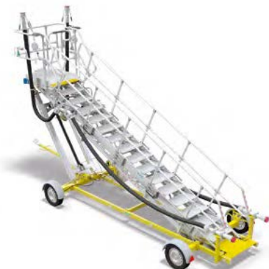
Betankungsbühne mit höhenverstellbarer Plattform (1,930 bis 3,250 mm bzw. 2,490 bis 4,250 mm). Sie wird mithilfe einer hydraulischen Handpumpe auf die benötigte Arbeitshöhe gebracht.
