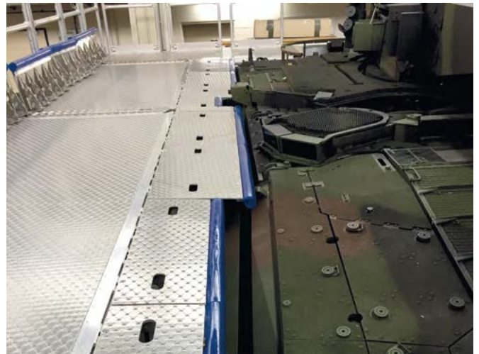
Steckbare Konturanpassungen schaffen einen sicheren Arbeitsplatz und ermöglichen den Zugang zu verschiedenen Bereichen des Fahrzeugs.
