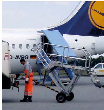
Einachsige Betankungsbühne in besonders leichter Ausführung. Die Bühne lässt sich ohne Weiteres durch eine Einzelperson am Schleppfahrzeug befestigen und manövrieren.
