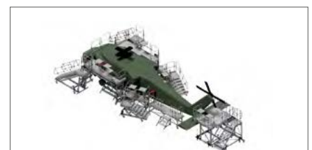
Diese beiden höhenverstellbaren Arbeitsbühnen mit Konturanpassungen ermöglichen optimale Wartungsarbeiten am Black Hawk
