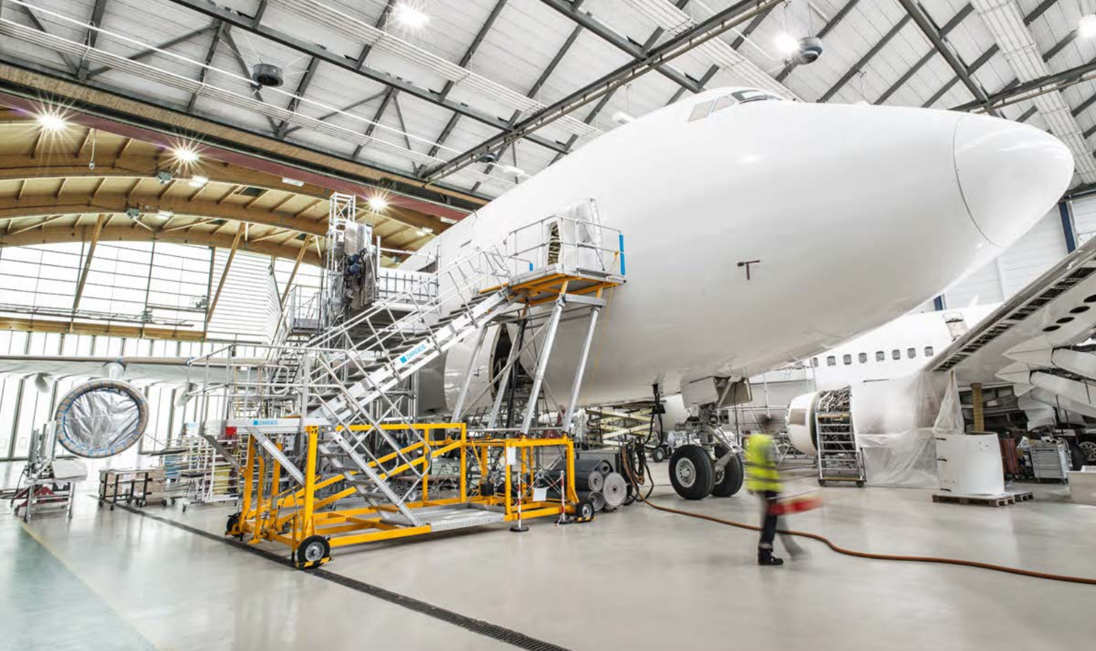
Verschiedene Arbeitsbühnen als sichere Zugänge zu Pax-, Cargo- und Service-Türen
